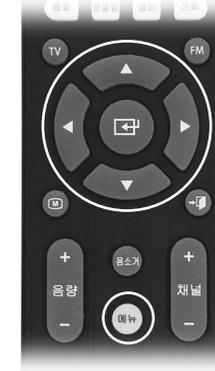
1. TV의 기능 및 상태의 설정을 편하게 하기 위해 OSD(On Screen Display) 형태로 메뉴를 제공하고 있습니다. 리모컨의 [메뉴 ]버튼 또는 본체의 [메뉴]버튼을 누르면 아래와 같은 창이 나타납니다. 리모컨의 [메뉴항목이동 ]버튼 또는 본체의 [메뉴 이동(상 / 하 / 좌 / 우 )]버튼을 눌러서 화면, 음향, 채널, 설정의 항목으로 이동하실 수 있습니다.
